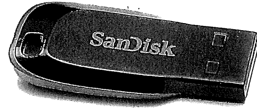
Ett USB-minne består av flashminnen, minnen som behåller datan efter att strömmen stängts av. Minnet i bilden lagrar 32 GB.
